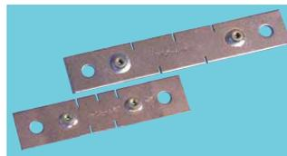
aux **constructeurs** de machines, d'équipements électroniques et électrotechniques de puissance. Elle est **particulièrement économique**, du fait que le raccordement s'effectue directement sur la lame de manganine (avec quelques précautions). La gamme existe de 10 à 300 A, uniquement en classe 1, et pour 50, 60 ou 100 mV de chute de tension. Les 100 mV sont tenus en stock.
