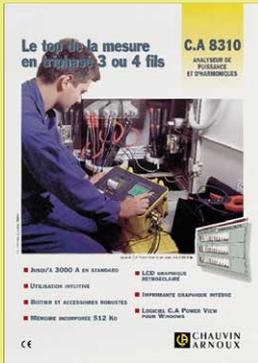
Avec cet analyseur de réseau et d'énergie, en boîtier chantier autonome, mesurez et affichez plus de quarante valeurs : tension, intensité, fréquence, puissances, énergies, facteur de puissance, harmonique, ...
