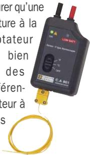
Vous devez simplement disposer d'un multimètre numérique à entrée mV<sub>DC</sub> et d'impédance minimum 2 MΩ. Ses bornes Ø 4 mm doivent être distantes de 19 mm (c'est l'entraxe standard du matériel conforme aux normes actuelles) pour y embrocher directement l'adaptateur. Ainsi, vous formez un ensemble solidaire qui se manipule aussi aisément qu'un
