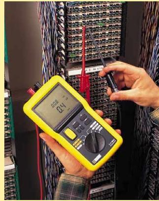
Effectuées sur des câbles neufs sous 250 V ou 500 V ou sur des lignes téléphoniques en service sous 50 V ou 100 V pour la relève de dérangements, les mesures d'isolement peuvent s'effectuer entre lignes appariées et l'écran relié à la terre, ou entre l'écran métallique et la terre.
