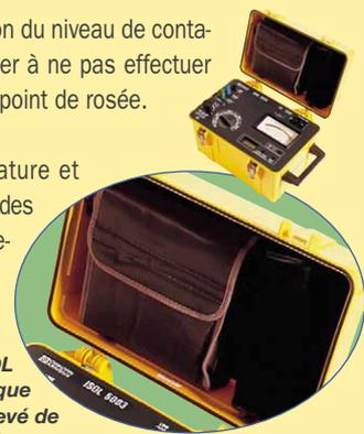
*Dans la pochette d'accessoires, fournie avec l'ISOL 5003, l'utilisateur dispose d'un thermomètre numérique avec une sonde d'air ambiante pour optimiser le relevé de conditions de mesures.*
