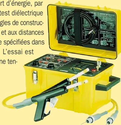
sion alternative, mais il peut également être réalisé avec une tension continue. L'appareil nécessaire à ces mesures est un **diélectromètre**. Le résultat obtenu est une valeur de tension, exprimée le plus souvent en kilovolt (kV). L'essai diélectrique présente un caractère plus ou moins destructif en cas de défaut, selon la puissance de l'appareil de test utilisé. De ce fait, il est réservé aux matériels neufs ou rénovés : seuls ceux ayant subi l'épreuve avec succès seront mis en service.
